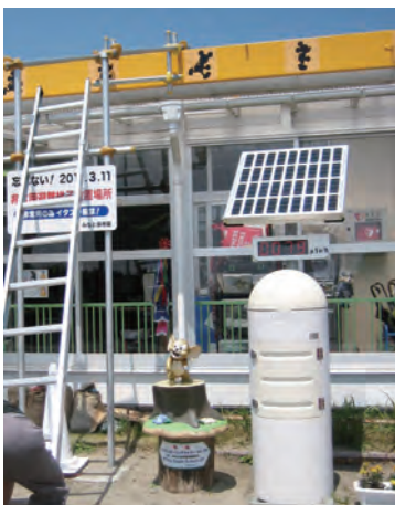
みなと保育園に設置された放射線モニタリングポスト
